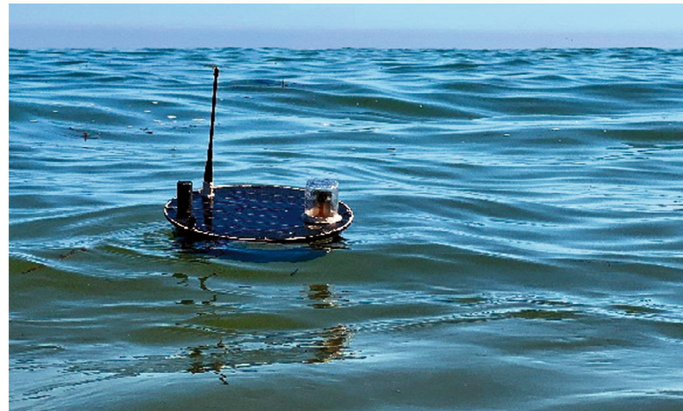
Flydende passiv sensor, der er en del af DARPA's forsøg med et Ocean of Things, hvor tusinder af bøjler og sensorer indsamler informationer. Bøjlerne har et års levetid og synker til bunds derefter. De lever op til amerikanske krav om biosikkerhed.
