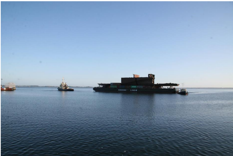
Billede 3 Første sektion af skroget til F361 IVER HUITFELDT af IVER HUITFELDT-klassen ankommer til Lindø Skibsværft den 19. maj 2008. Skrogene blev bygget i Estland og Litauen som dele og samlet på Lindø. Foto Forsvarets Mediecenter – Forsvarsgalleriet.
