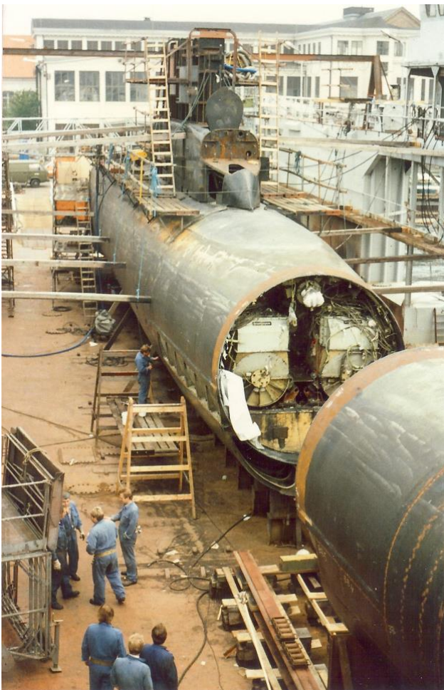
Billede 2 NARHVALEN i dok på Orlogsværftet for hovedeftersyn af hovedmotor og dieselmotorer. Fra sidst i 1980'erne. Fotograf: John Ærø Hansen - Forsvarsgalleriet
